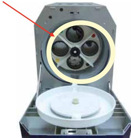
4. **Supports de PADS.** Utilisez un tissu sec pour les parties en plastique et métalliques et éliminer les résidus solides. Evitez de mouiller le VELCRO.
