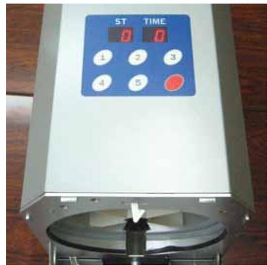
Il n'est pas possible d'initialiser la machine avec la porte ouverte. Fermez-la auparavant. Si celle-ci reste ouverte, l'écran de LEDs vous indiquera le message d'alerte suivant : (ST="AL", TIME = 11). Fermez la porte et appuyer sur une touche pour réinitialiser.
