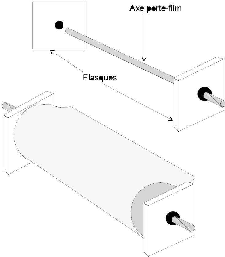
**P**ositionner le rouleau sur l'axe porte-film, papier siliconé quadrillé vers vous.
