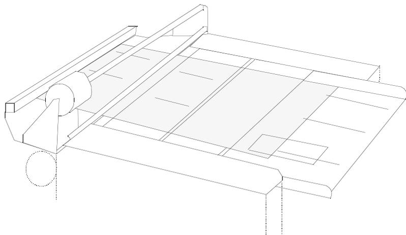
**1 - Tirer le film jusqu'au chiffre repéré sur le tableau de coupe du film**
